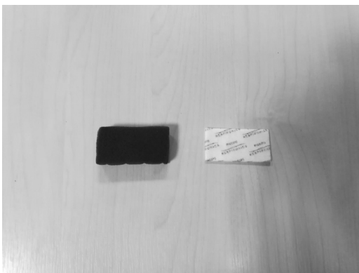
รูปที่ 9. ตัวอย่างแผ่นกรองที่สามารถทำความสะอาดแล้วนำมาใช้ซ้ำได้ (ซ้าย) และแผ่นกรองที่ใช้ครั้งเดียวแล้วทิ้ง (ขวา)
