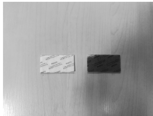
รูปที่ 14. ตัวอย่างแผ่นกรองที่สะอาดพร้อมใช้ (ซ้าย) และแผ่นกรองที่เสื่อมสภาพไม่เหมาะแก่การใช้งาน (ขวา)
