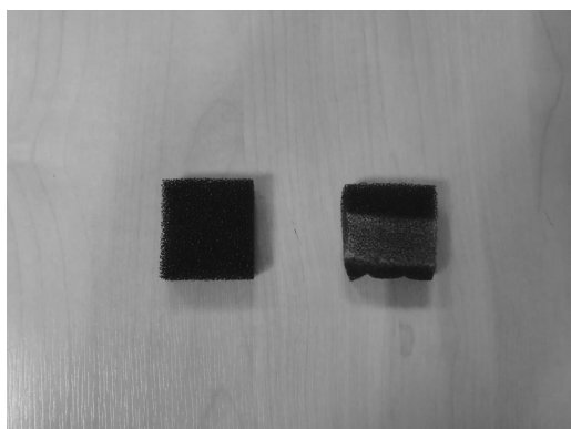
รูปที่ 12. ตัวอย่างแผ่นกรองที่สะอาดพร้อมใช้ (ซ้าย) และแผ่นกรองที่ควรนำไปทำความสะอาด (ขวา)
