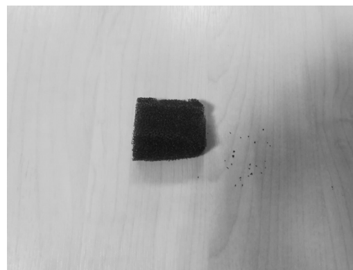
รูปที่ 13. ตัวอย่างแผ่นกรองที่เสื่อมสภาพเริ่มมีการเปื่อยยุ่ย ไม่เหมาะแก่การนำไปทำความสะอาดและนำกลับมาใช้
