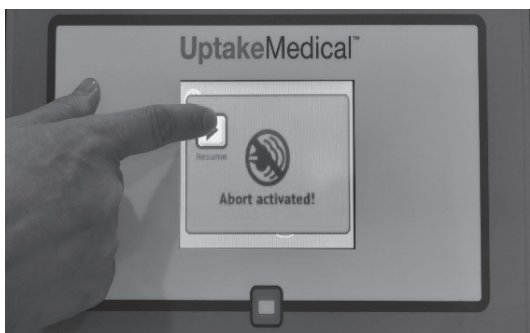
รูปที่ 36. แสดงภาพการกดปุ่ม Resume บนหน้าจอหลักเมื่อต้องการให้ระบบกลับมาทำงานอีกครั้ง
