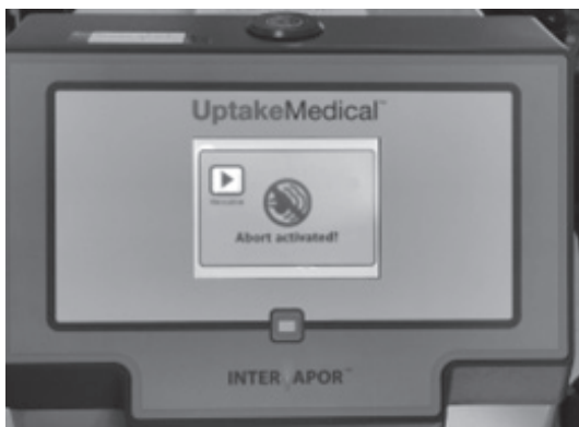
รูปที่ 34. แสดงภาพหน้าจอหลังการกดปุ่ม System Abort หน้าจอเครื่องจะขึ้น “Abort activated.”
