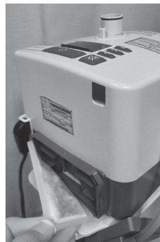
รูปที่ 14. ขั้นตอนการเปลี่ยนแผ่นกรองอากาศด้านหลังตัวเครื่อง High Flow Nasal Cannula (HFNC) โดยจะเปลี่ยนทุก 3 เดือน หรือ 1,000 ชั่วโมง ที่มา : ถ่ายภาพโดย นายณัฐพล พรหมดี
