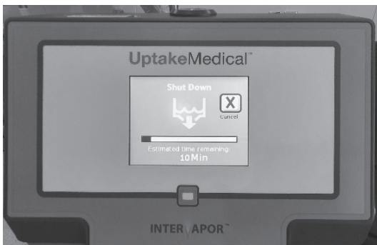
รูปที่ 30. แสดงภาพหน้าจอระบายน้ำ ออกจากเครื่องกำเนิด
