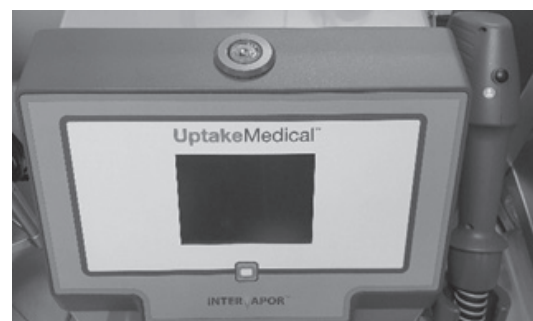
รูปที่ 33. แสดงภาพปุ่ม System Abort เมื่อต้องการหยุดการทำงานทั้งระบบ
