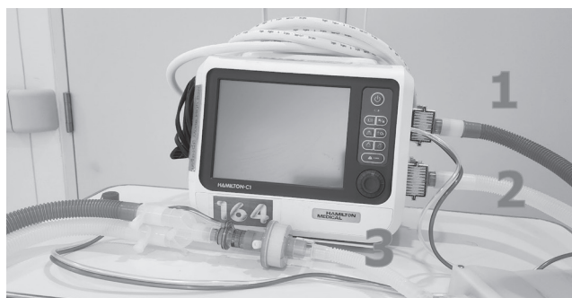
รูปที่ 9. แสดงการต่อตัวกรองแบคทีเรียเข้ากับเครื่องช่วยหายใจแบบเคลื่อนย้าย 3 จุด จุดที่ 1 และ 2 ต่อกับ bacteria filter แบบธรรมดา จุดที่ 3 ต่อกับ HME bacteria filter ภาพถ่ายโดยนายสาธิต บุญฤทธิ
