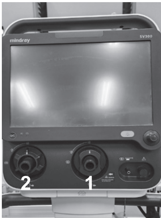
รูปที่ 6. แสดงช่องทางลมของเครื่องช่วยหายใจขาเข้า (1) และขาออก (2) จากตัวผู้ป่วย ภาพถ่ายโดยนายสาธิต บุญฤทธิ
